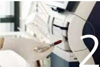
2 La sonda realizará una autolimpieza y aspirará automáticamente la muestra de la jeringa, el capilar o el tubo de ensayo.
