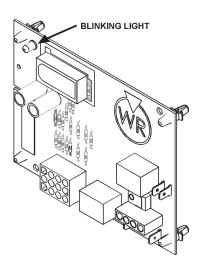
FIGURE 4-IGNITION CONTROL BOARD
