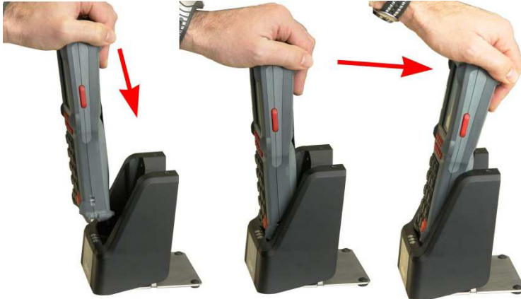
Figura 125: inserción del M260SE en la DS260
