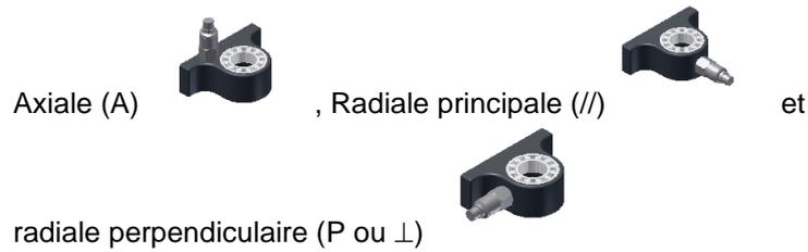
\*\*\*\* Photographie de la position du capteur : il est possible de remplacer le pictogramme par une photo du capteur.
