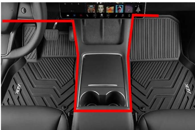
(3) 拆下马鞍两侧饰板，左侧前后门把手线材按照上图走线至副驾驶控制盒放置位置，控制盒隐藏在饰板里面
