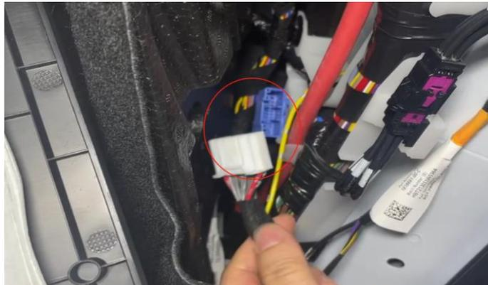
(2) .拆下副驾 A 柱饰板 CAN 线直接与蓝色插座对插
