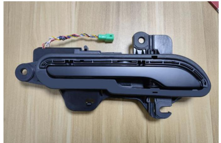
(8). 将第二代把手安装到车上 插头直接对插原车，用原车螺丝固定好把手即可
