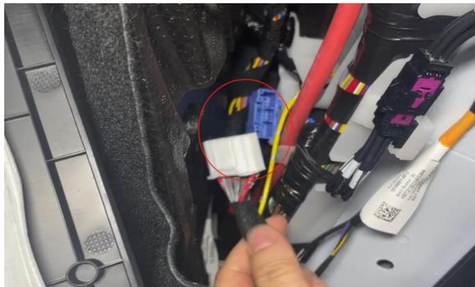
(2) 拆下副驾 A 柱饰板 CAN 线直接与蓝色插座对插
