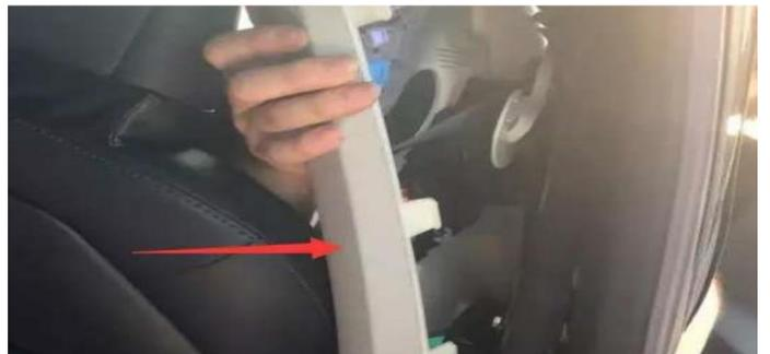
(12).拆下 B 柱上边饰板 用穿线绳将把手线从波纹管穿到车内，线材隐藏在车边沿饰板内
