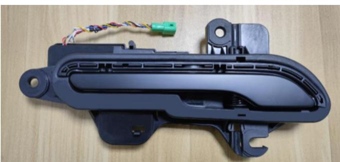
(11).将第二代把手安装到车上插头直接对插原车，用原车螺丝固定好把手即可
