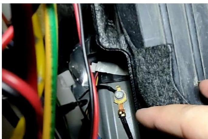
(4) 在主驾驶脚踏旁边接地线。接好之后测试把手，把手工作正常即可恢复车门饰板
