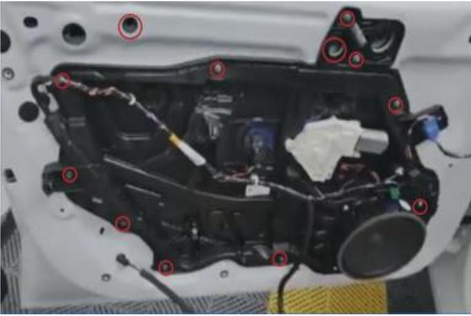
(5). 拔掉所有插头取下标记的所有螺丝拿下饰板
