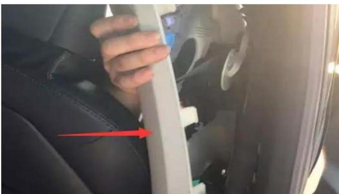
(9). 拆下 B 柱上边饰板 用穿线绳将把手线从波纹管穿到车内，线材隐藏在车边沿饰板内
