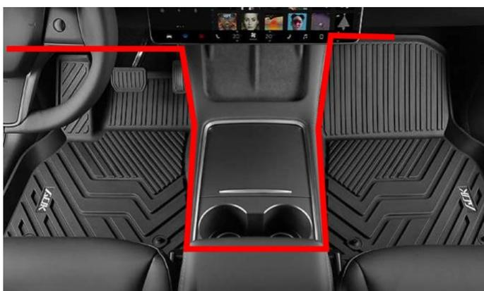
(3) .拆下马鞍两侧饰板，左侧前后门把手线材按照上图走线至副驾驶控制盒放置位置，控制盒隐藏在饰板里面
