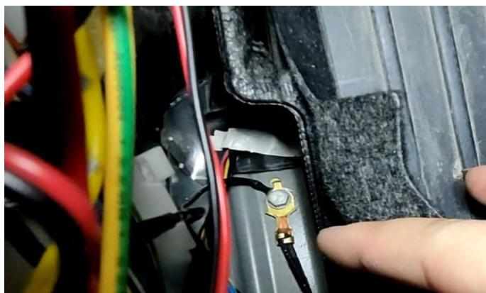
(4) .在主驾驶脚踏旁边接地线。接好之后测试把手，把手工作正常即可恢复车门饰板
