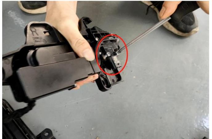
(10).将原车上的信号器拆装到相对应的电动把手上，用原车螺丝固定
