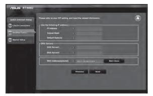
**5.** Atribua o nome de rede (SSID) e a chave de segurança para a sua ligação sem fio a 2,4GHz e 5GHz. Clique em **Apply (Aplicar)** quando terminar
