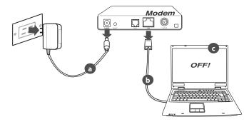
**ADVERTENCIA!** Antes de desconectar todos los cables, asegúrese de que el módem por cable/ADSL haya permanecido apagado durante, al menos, dos minutos. Si el módem tiene una batería de reserva, quítela también.
