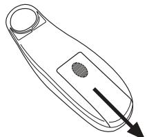
Retire la tapa de la batería del reverso del mando a distancia.
