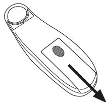
Faites glisser le couvercle de la pile à l'arrière de la télécommande.
