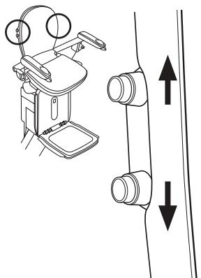
Si un repose-pieds motorisé est installé, en haut ou en bas de l'escalier, après l'arrêt du monte-escalier, détachez la ceinture de sécurité et quittez le monte-escalier.
