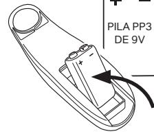
Inserte primero la base de la nueva pila y empuje hacia abajo con firmeza hasta encajarla correctamente.
