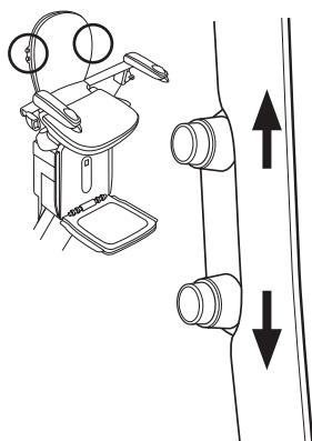
Si se dispone de un reposapiés automático, en la parte superior o inferior de las escaleras, una vez que la silla salvaescaleras se haya detenido, desabóchese el cinturón de seguridad y abandone la silla.
