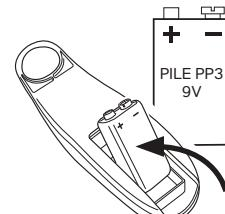
Insérez d'abord la base de la nouvelle pile et poussez-la fermement. Replacez le couvercle.
