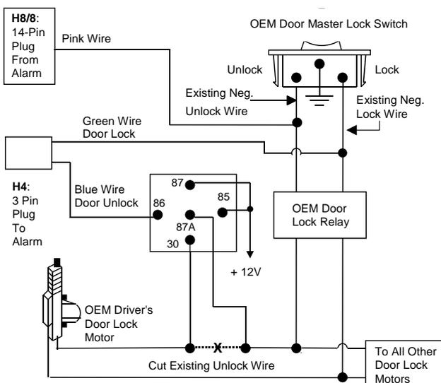
**2 STEP DOOR UNLOCK WIRE CONNECTION FOR POSITIVE SWITCHED DOOR LOCKS**
