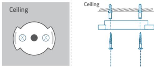
4. Lijn de groeven uit met de montageplaat en draai de Indoor Cam met de klok mee tot dat deze op zijn plaats klikt.
