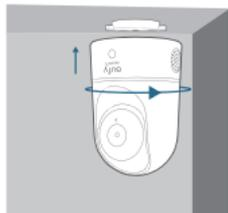
Zur Montage der Indoor Cam an einer Wand empfehlen wir die Verwendung der Montagehalterung (nicht mitgeliefert) wie in der Abbildung unten dargestellt.
