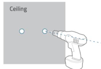
3. Alignez les trous sur la plaque de montage à ceux du plafond. Insérez les ancrages dans les trous ; les ancrages sont nécessaires pour les murs faits de matériaux durs tels que le béton, la brique ou le stuc. Fixez les vis avec un tournevis cruciforme pour fixer la plaque de montage au plafond.
