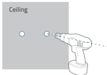
3. Allineare i fori sulla piastra di montaggio con quelli sul soffitto. Inserire i tasselli all'interno dei fori, necessari nei casi in cui le pareti siano in materiali duri come calcestruzzo, mattoni o stucco. Fissare le viti con un cacciavite a stella per fissare la piastra di montaggio al soffitto.
