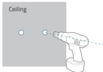
3. Lijn de gaten op de montageplaat uit met de gaten in het plafond. Inserire i tasselli all'interno dei fori, necessari nei casi in cui le pareti siano in materiali duri come calcestruzzo, mattoni o stucco. Gebruik een kruiskopschroevendraaier om de schroeven vast te draaien en de montageplaat aan het plafond te bevestigen.
