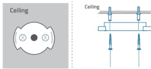
4. Alinee las ranuras de la placa de montaje y gire la cámara de interior eufy en sentido de las agujas del reloj hasta que encaje en su lugar.
