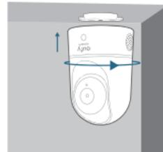
Per montare la telecamera per interni su una parete, si consiglia di utilizzare la staffa di montaggio (non fornita) come nella figura seguente.
