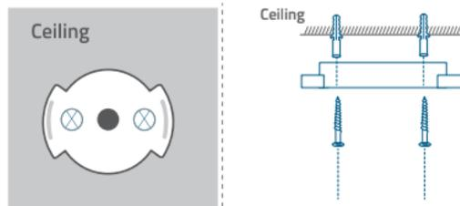
4. Allineare le scanalature con la piastra di montaggio e ruotare la telecamera per interni in senso orario fino a quando non scatta in posizione.
