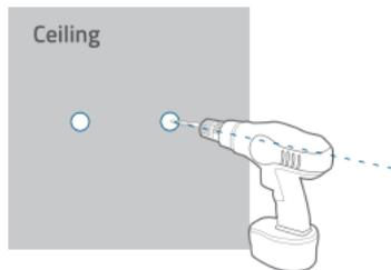
3. Alinee los orificios de la placa de montaje con los orificios taladrados en el techo. Inserte los tacos dentro de los orificios; es necesario utilizar los tacos en paredes que están hechas con materiales duros, como hormigón, ladrillo o estuco. Apriete los tornillos con un destornillador Phillips para fijar la placa de montaje al techo.
