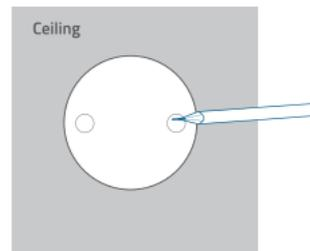
2. Bohren Sie die Löcher mit einem 8-mm-Bohrer.
