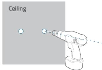
3. 取り付けプレートの穴を天井の穴に合わせてください。アンカープラグを穴に挿入してください。アンカープラグは、コンクリート、レンガ、漆喰などの硬い材料で作られた壁に必要です。プラスドライバーでネジを固定して、取り付けプレートを天井に取り付けてください。
