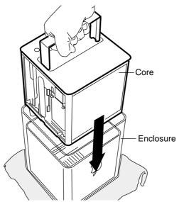
Core : Systemeinheit Enclosure : Gehäuse 2. Drücken Sie auf den Griff, bis er einrastet. Drücken Sie kräftig auf die Systemeinheit, um sicherzustellen, dass sie sicher im Gehäuse eingesetzt ist.
