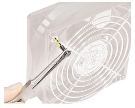
2. Verwenden Sie die vier mit dem neuen Ventilator gelieferten Schrauben, um das Schutzgitter am neuen Ventilator zu befestigen.
