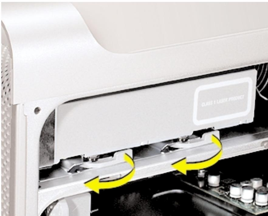
3. Stecken Sie die Finger einer Hand in die Öffnung für das Kabel des optischen Laufwerks und schieben Sie das Laufwerk nach vorne. Das Laufwerk wird ein Stück aus der Ablage heraus bewegt. (**Abbildung 6**)
