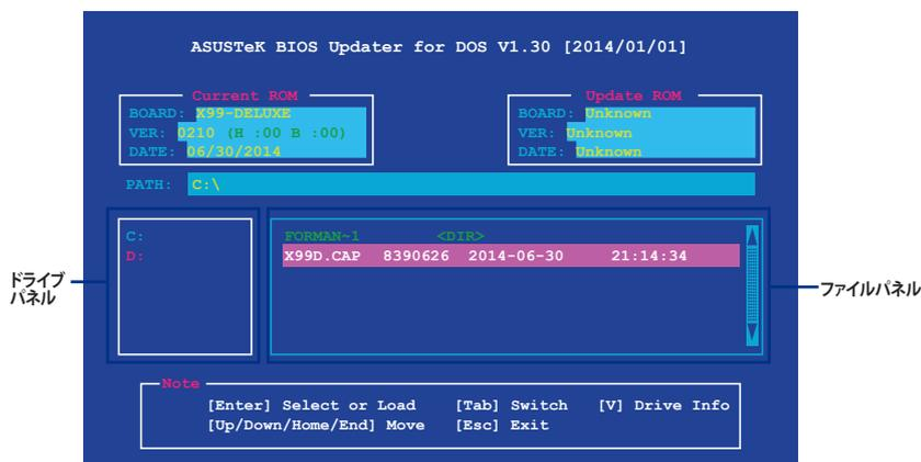
3. <Tab>でパネルを切り替え、BIOSファイルの保存されたUSBメモリードライブを選択し<Enter>を押します。次に、カーソルキーで更新に使用するBIOSファイルを選択して<Enter>を押します。BIOS Updaterは選択したBIOSファイルをチェックし、次のような確認画面が表示されます。
