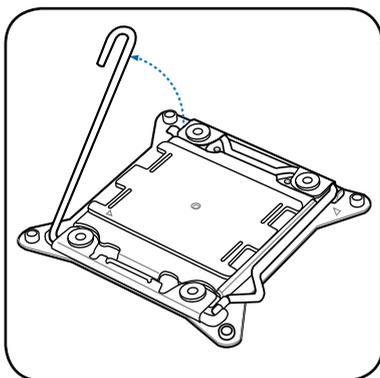
4. 用姆指按下右边固定扳手 (C)，并将它移到右侧 (D) 直到脱离固定扣。依箭头方向轻轻抬起固定扳手 (E)。
