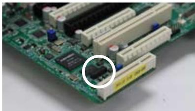
2. 将 ASMB6 管理卡向下插入。
