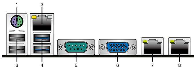
1. PS/2 键盘/鼠标接口：将 PS/2 键盘/鼠标插头连接到此端口。
