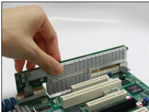
3. 将 RAID 卡插入 PIKE RAID 卡插槽。请确认卡完全插入到 PIKE RAID 卡插槽中。
