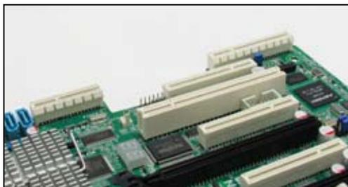
2. 将 RAID 卡的金手指按正确的方向对准 PIKE RAID 卡插槽位置。
