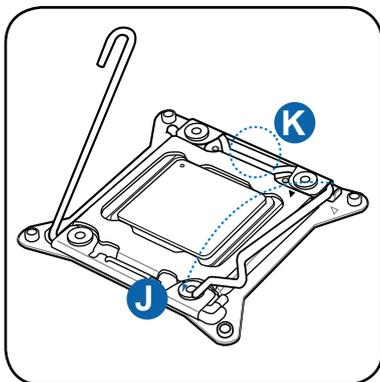
9. 将右侧固定扳手插入固定扣下。
