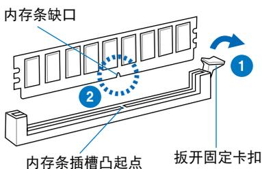
3. 最后缓缓将内存条插入插槽中，若无错误，插槽一端的白色卡扣会因内存条置入而自动扣到内存条两侧的凹孔中。
