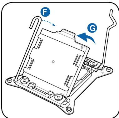
6. 小心地将 CPU 放入插槽，确认三角标志对准插槽右上角。
