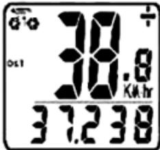
**VITESSE MAXIMUM (MXS)** – La vitesse maximum est indiquée par le sigle MXS et est affichée sur la ligne du bas. La vitesse maximum est enregistrée dans la mémoire et ne s'actualise que si l'on atteint une vitesse supérieure. Pour remettre la valeur MXS à zéro, appuyer sur le bouton CONFIG (SET) et le maintenir enfoncé pendant deux secondes. Appuyer ensuite sur l'un ou l'autre des boutons MODE pour passer au mode Vitesse moyenne (AVS).
