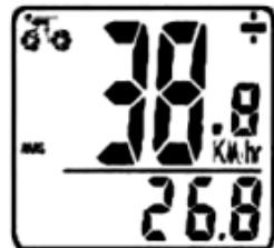
**RÉTROÉCLAIRAGE EL** – Le rétroéclairage EL permet d'illuminer l'écran de l'ordinateur de manière à faciliter la lecture lorsque la lumière est faible ou que l'on se trouve dans l'obscurité. On peut le configurer de deux façons :
