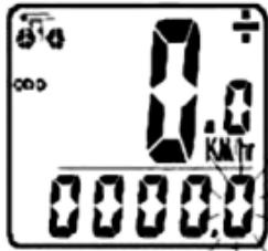
**VITESSE MOYENNE (AVS)** – La vitesse moyenne est indiquée par le sigle AVS et est affichée sur la ligne du bas. La vitesse moyenne fonctionne de pair avec le Chronométrage (TM) pour le calcul de la vitesse moyenne d'une course particulière. Appuyer sur l'un ou l'autre des boutons MODE pour passer au mode Chronométrage (TM).
