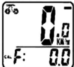
**BALAYAGE (SCAN)** – Le mode Balayage fait passer commodément de l'un à l'autre des écrans DST, MXS, AVS ou TM de l'ordinateur sans besoin d'appuyer sur aucun bouton. Appuyer ensuite sur l'un ou l'autre des boutons MODE pour passer au mode Horloge (CLOCK).
