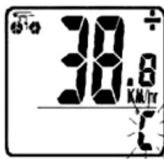
**TEMPÉRATURE (TEMP)** – L'ordinateur comporte un thermomètre mesurant la température extérieure. Pour choisir entre les unités degré Celsius (°C) ou Fahrenheit (°F), appuyer sur le bouton CONFIG (SET) et le maintenir enfoncé pendant deux secondes. Appuyer sur l'un ou l'autre des boutons MODE pour choisir entre C et F et appuyer sur le bouton CONFIG (SET) pour confirmer. Appuyer ensuite sur l'un ou l'autre des boutons MODE pour passer au mode Calories brûlées (CAL).
