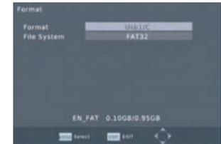
Drücken Sie <▲> oder <▼> um das Dateisystem zu markieren, anschließend betätigen Sie <◀> oder <▶> um zwischen FAT32 und NTFS auszuwählen. Drücken Sie <▲> oder <▼> um das Format zu markieren und anschließend <OK>. Drücken Sie nochmals <OK>, startet die Formatierung. Mit <EXIT> gelangen Sie zurück in das Formatierungs-Menü.
