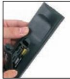
Stecken Sie die neue Batterie mit der + Seite nach oben ein.
