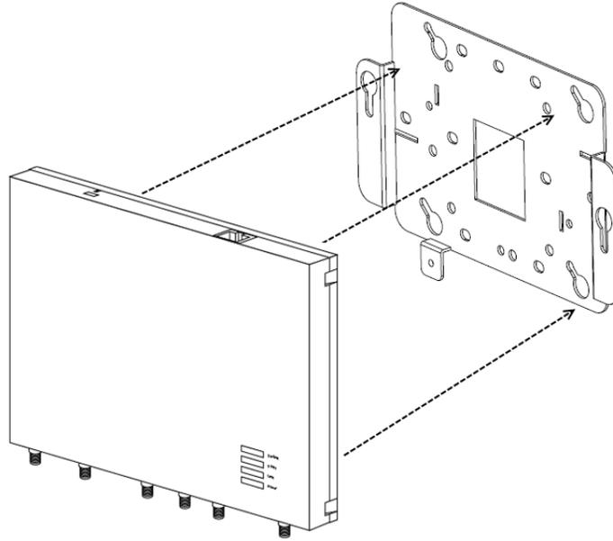
6. Faites glisser le point d'accès dans les encoches en trous de serrure en veillant à ce que ses languettes de montage soient correctement installées dans la partie inférieure des encoches.
