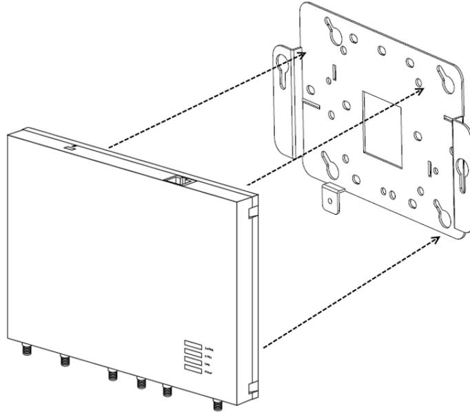
6. Schieben Sie den Access Point vorsichtig in den Längsschlitz nach unten, sodass die Montagelaschen des Access Point am unteren Rand der Längsschlitz aufsitzen.
