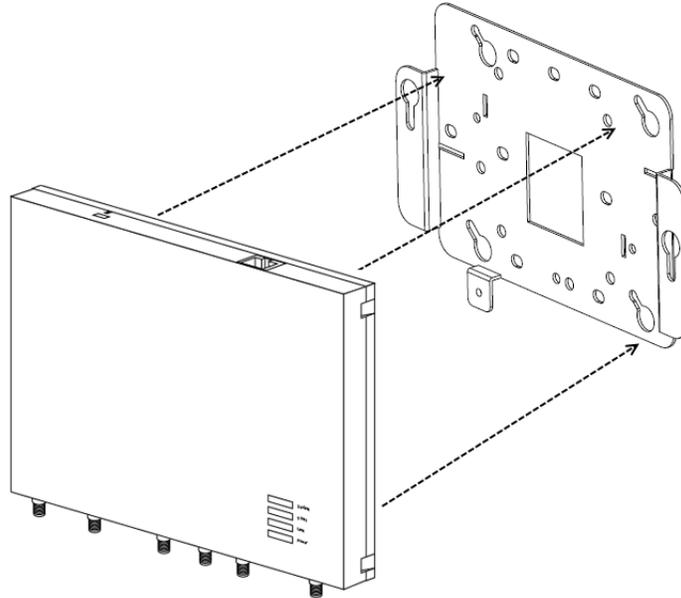
6. Permita que el punto de acceso se deslice por las ranuras con forma de cerradura, asegurándose de que las lengüetas de montaje del punto de acceso estén asentadas en la parte de abajo de la ranura.
