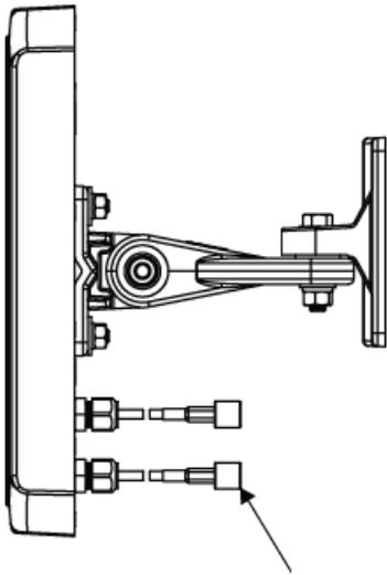
Der Adapter für die Deckenmontage verfügt über zwei ineinander greifende Halterungen. Die Montagelaschen unten am Access Point passen in die Längsschlitz an der größeren Halterung. Die unverlierbare Schraube am Access Point wird in das Gewindeloch an der größeren Halterung geschraubt. Die unverlierbare Schraube an der kleineren Halterung kann je nach Rastergröße auf zweierlei Weise an der größeren Halterung ausgerichtet werden.
