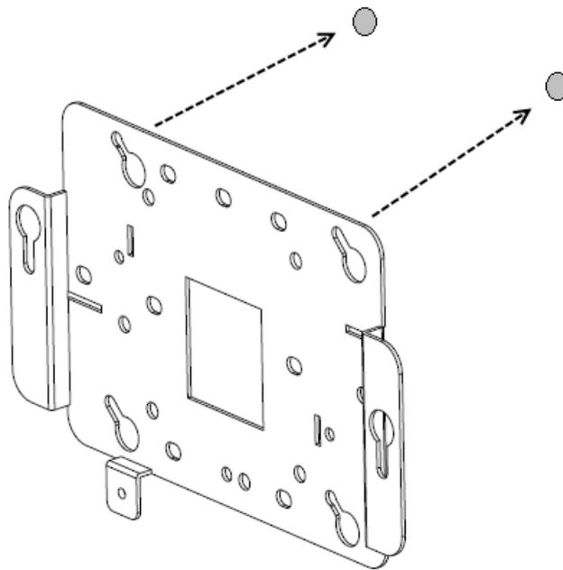
4. Aperte os parafusos para segurar com firmeza o suporte de montagem contra a parede.
