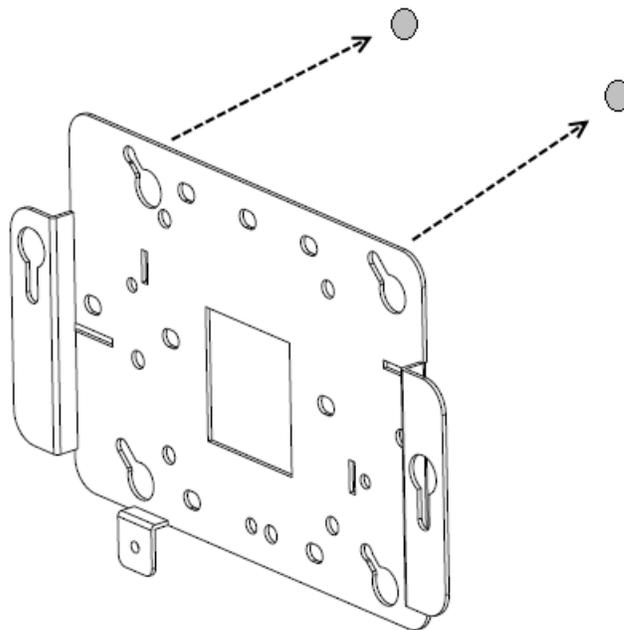
4. Ajuste los tornillos para fijar el soporte de montaje de pared con firmeza contra la pared.
