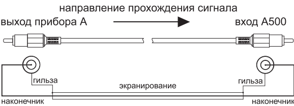
Рис. 4.4 Несимметричное подключение с помощью кабеля с RCA- разъемами
