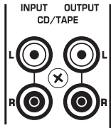
Fig. 2.10: Las tomas de conexión de dos pistas
