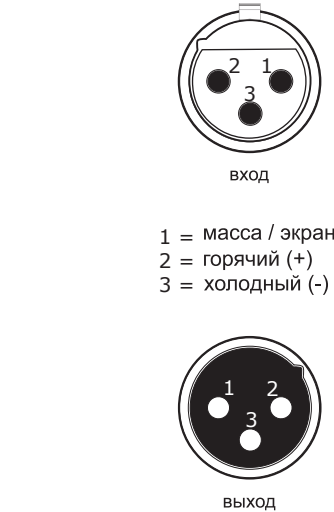
При несимметричном соединении контакты 1 и 3 должны быть перемкнуты.
