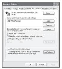
2 Cliquer sur l'onglet **Connections** (Connexions), puis sélectionner **Never dial a connection** (Ne jamais établir de connexion). S'il n'est pas possible d'effectuer une sélection, passer à l'étape suivante.
