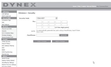
La tarjeta de red inalámbrica G para computadora de sobremesa no puede acceder a la red porque emplea una clave de red diferente de la configurada en el enrutador inalámbrico G mejorado.
