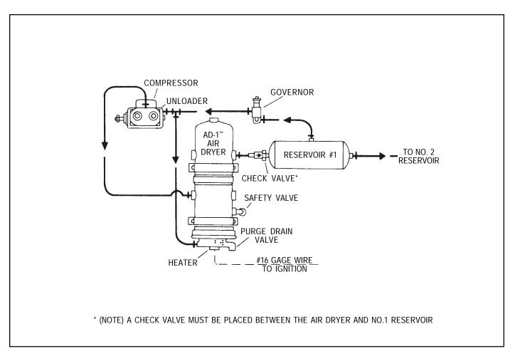
FIGURE 19 - TYPICAL INSTALLATION FOR THE AD-1™ AIR DRYER
