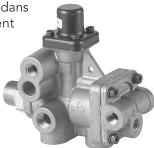
La caractéristique de non-addition des efforts de freinage de la valve accroît la robustesse et assure une meilleure détection des pannes en évacuant l'air de manière audible par la soupape de protection située à l'arrière de la cabine du tracteur.
