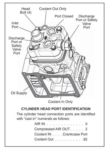
FIGURE 7 - 360cc SINGLE CYLINDER COMPRESSOR PORT IDENTIFICATION
