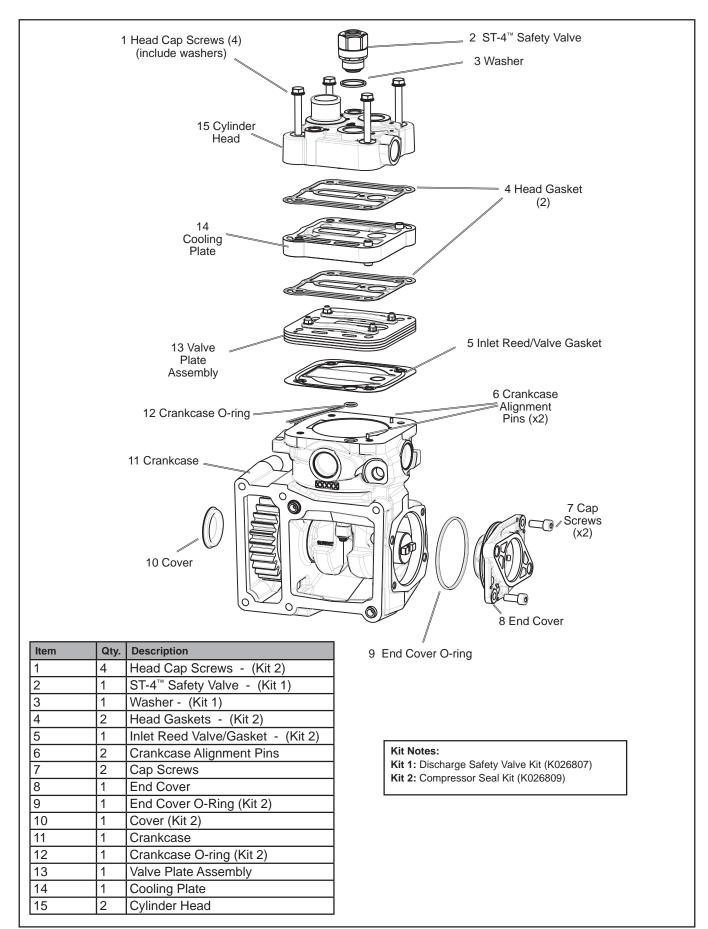
FIGURE 8 - 360cc SINGLE CYLINDER COMPRESSOR EXPLODED VIEW
