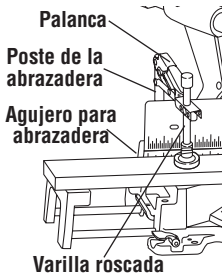
Figura 21a. Abrazadera de acción rápida
