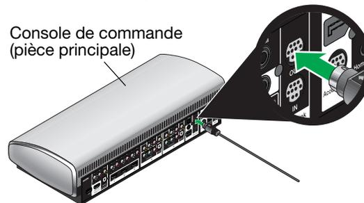
2. Connectez l'autre extrémité du câble Bose Link à l'appareil d'extension.
