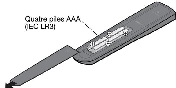
2. Localisez les repères de polarité (+ et -) situés à l'intérieur du compartiment, et insérez en conséquence les quatre piles fournies.
