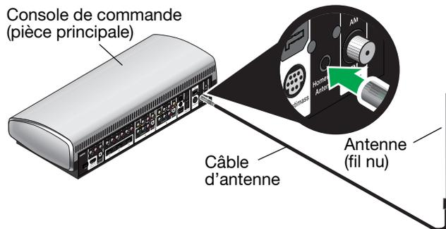
Dans la mesure où le signal rayonne à 90° autour de l'antenne (fil nu), il est préférable de monter celle-ci à la verticale et le plus près possible du centre de votre logement.
