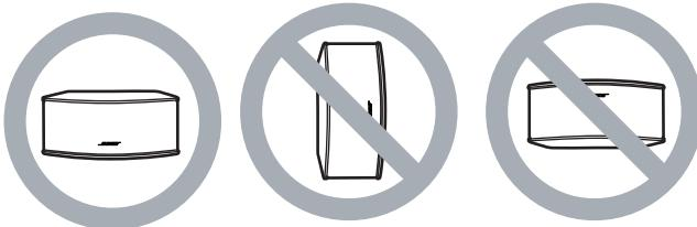
♪：上下を逆にしたり、縦にして使用すると、本製品のサラウンド効果が著しく低下します。必ず水平に上下左右を正しく設置するようにしてください。
