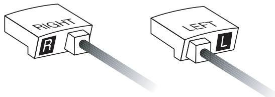
♪ 注意：モデル3・2・1GSシステムは、その独自のサラウンド再生方法により音の左右を間違えると全く効果が得られなくなります。くれぐれも右に設置されたジュエルアレイ・スピーカーには右用のスピーカーコードを、左に設置されたジュエルアレイ・スピーカーには左用のスピーカーコードを接続してください。
