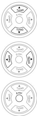
チューナー時、AM/FMラジオの受信周波数を上げ/下げするボタンです。オンスクリーンディスプレイを表示しているときは上下の項目を選択するときに使います。
