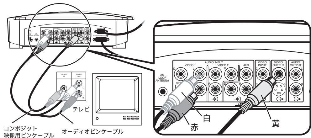
♪ 注意：テレビの映像入力端子をメディアセンターの映像出力端子にコンポジット(同軸)ケーブル(黄色のピンプラグのケーブル)で接続している場合は、ビデオデッキの映像出力端子とメディアセンターの映像入力端子もコンポジット(同軸)ケーブル(黄色のピンプラグのケーブル)で接続してください。市販のS映像ケーブルで接続する場合は、すべての映像の接続をS映像ケーブルで接続してください。音声信号の接続はRCAピンケーブルを使用します。
