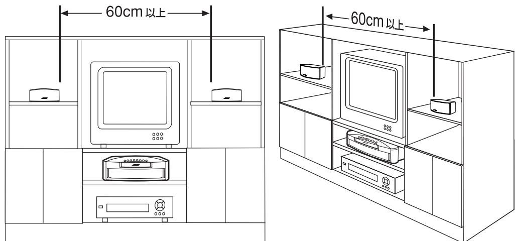
⚠ 警告：スピーカーを設置する部分がガラスや磨き込んだ板、つるつる滑るような材質のものの上などは、スピーカーが音を出したときの振動などで滑って落下する恐れがあります。このような場所に設置する場合は必ず付属のゴム足を使用して、落下しないように安全に設置してください。
