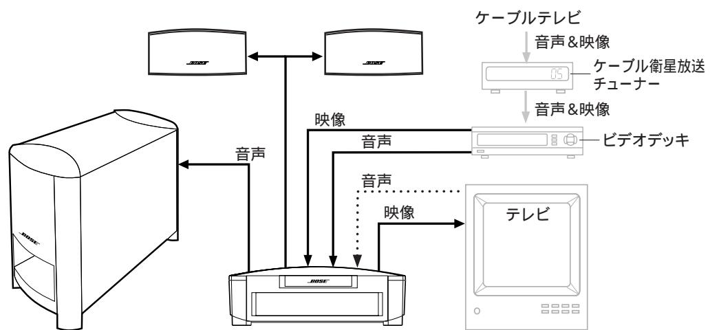
図20の接続方法では、衛星チューナーとケーブルテレビチューナーのどちらもがビデオデッキに接続され、ビデオデッキの音声出力がテレビに接続されています。そして、テレビの音声出力がメディアセンターに接続されています。これはメディアセンターの1つの音声入力端子(例えばVIDEO 1)を使ってすべての音声を再生することができる、衛星チューナー、ケーブルテレビチューナー、ビデオ、テレビの再生をメディアセンターのソース切り換えなしで楽しめます。
