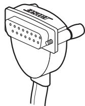
♪：コネクターを固定するときにこのネジを締めると、接触不良などのトラブルを防ぐ事ができます。また、ネジを締める時にドライバー(ネジ回し)を使うと破損する場合がありますので、必ず手で締めるようにしてください。このコネクターは手で締める力で十分固定できるようになっています。ネジをゆるめる場合はドライバー(ネジ回し)を使用してもかまいません。
