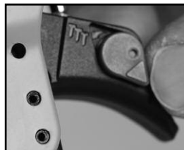
Mode de déclenchement séquentiel (sélecteur de mode de déclenchement pointant vers le bas)
