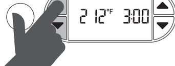
9. Pressez le bouton HOT WATER pour enclencher le cycle. Le contour du bouton s'allumera et l'écran ACL affichera 'ON'. Une fois que la température de l'eau aura atteint 120°F/50°C, l'écran ACL suivra la progression du cycle de réchauffage en temps réel par tranches de 5°F/3°C.
