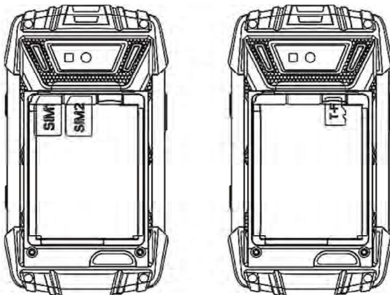
3. Inserte la batería, coloque la tapa de la batería y apriete girando los dos tornillos en sentido horario
