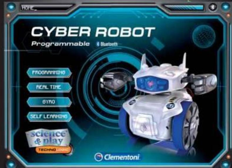
En la parte superior derecha de la pantalla, hay un símbolo de Bluetooth®, que puedes utilizar para conectar el dispositivo y comprobar si la conexión entre el robot y el dispositivo está encendida o apagada.
