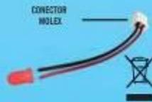
Un LED (Diodo emisor de luz) es un tipo especial de diodo que emite luz. Cuando recibe un pulso eléctrico, produce luz como respuesta. El primer LED lo desarrolló en 1952 Nick Holonyak Jr., un inventor americano.
