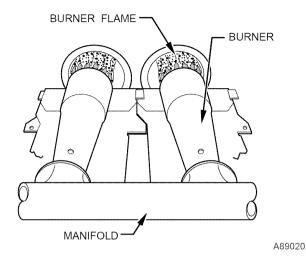
Fig. 54—Burner Flame
