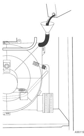
Fig. 51—Filling Condensate Trap
