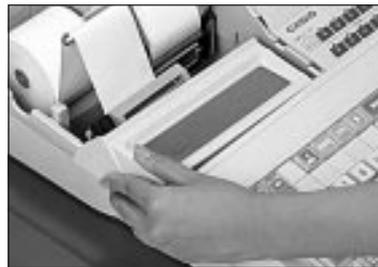
⑤ メモリーカセットカバーの右側部の「ツメ」の部分本体に入れてから、カバーの左端を上から下へ押しします。
