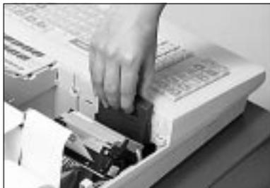
③ メモリーカセットの中央上部の「へコミ」に中指を掛けるようにしてカセットを持って、カセット挿入口に差し込みます。
