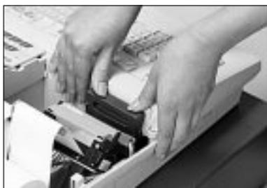
④ カセットの上縁部の左右を、両手の親指で同時に強く押して、カセットを下へ押し下げます。このとき、カセットが最後まで入るように十分に押し込んでください。
