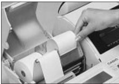
③ ロールペーパーの先端を「ジャーナル用紙挿入口」へ差し込みます。自動的にペーパーが引き込まれます。
