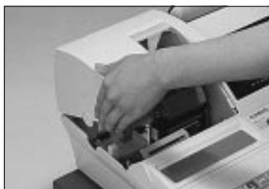
② プリンターカバーの「左側面手前の突起」に指をかけて、カバーの前部を持ち上げます。
