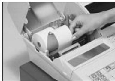
⑤ ロールペーパーの先端を、ガイドローラーの上から「レシート用紙挿入口」へ差し込みます。自動的にペーパーが引き込まれます。
