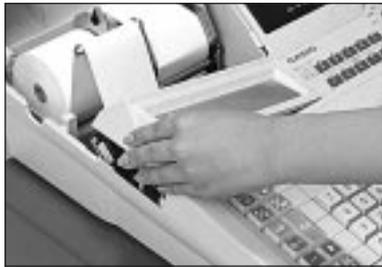
② メモリーカセットカバーの左側を持ち上げて、カバーを取り外します。
