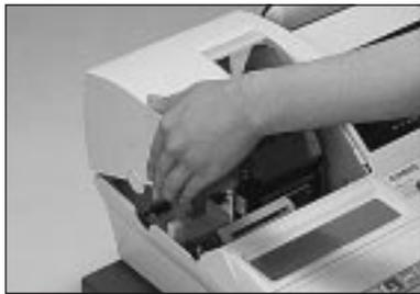
① モードスイッチを「OFF」にして、プリンターカバーの「左側面手前の突起」に指をかけて、カバーの前部を持ち上げます。
