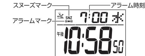
電波受信中にアラーム時刻セットボタンを押すと、電波受信は中断されます。
