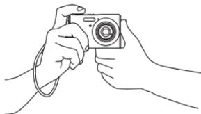
Segure a câmara conforme se indica na ilustração, com os seus braços firmes contra as suas partes laterais.
