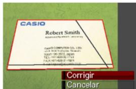
Isto exhibe uma tela que mostra todas as formas rectangulares na imagem que se classificam como candidatas à correção da distorção trapezoidal. Uma moldura de selecção vermelha circundará o candidato a correção actualmente seleccionado. Se houver uma moldura de selecção preta, isso indica um segundo possível candidato. Se não houver segundo candidato (moldura de selecção preta), vá directamente para o passo 3.
