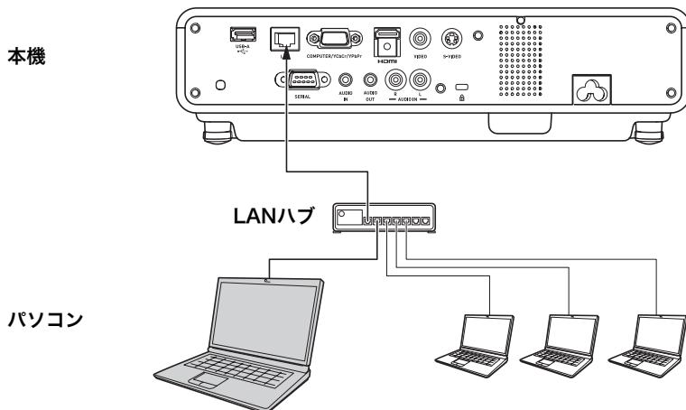
●上図のような接続では、一般にストレートタイプのLANケーブルを使用します。本機のLAN端子とパソコンのLAN端子を直接接続する場合は、クロスタイプのLANケーブルを使用してください。
