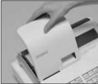
Ajuste el conmutador de modo a la posición REG y retire la cubierta de la impresora.
