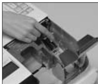
4. Vuelva a colocar la cubierta del compartimento de las pilas.
