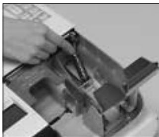
3. Observe las marcas (+) y (-) en el compartimento de las pilas. Coloque un juego de dos pilas alcalinas nuevas de forma que sus extremos positivo (+) y negativo (-) queden orientados de la manera indicada por las marcas.
