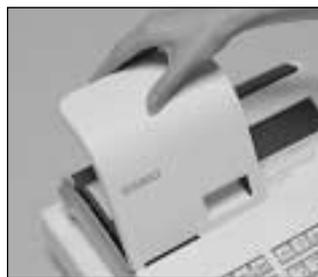
5. Cierre el brazo del rodillo y vuelva a colocar la cubierta de la impresora.
