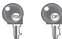
Hay dos tipos de llaves de modo. La llave de programa marcada "PGM" y la llave del operador marcada "OP". La llave de programa puede poner el interruptor de modo en cualquier posición, mientras que la llave de operador solamente puede seleccionar las posiciones de OFF, REG y CAL.
