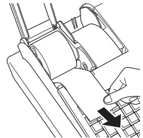
**5** Fermez lentement le bras du cylindre jusqu'à ce qu'il se verrouille en place.
