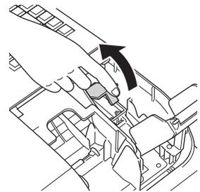
**3** Repérez les repères (+) et (-) à l'intérieur du logement des piles. Mettez en place deux piles neuves au manganèse de même marque de type « AA » de sorte que leurs bornes (+) et (-) se trouvent dans le sens indiqué par les repères.
