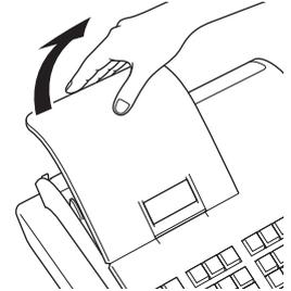
**2** Entfernen Sie den Batteriefachdeckel.
