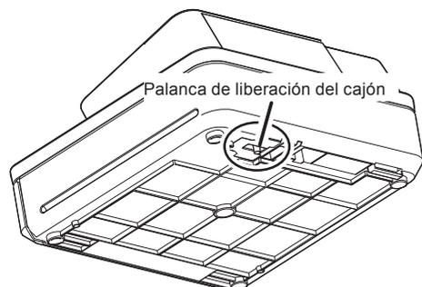
En caso de corte del suministro eléctrico o de que la máquina no funcione bien, el cajón de la registradora no se abrirá automáticamente. Incluso en estos casos, podrá abrir el cajón de la registradora deslizando la palanca de liberación del cajón (véase a continuación).
