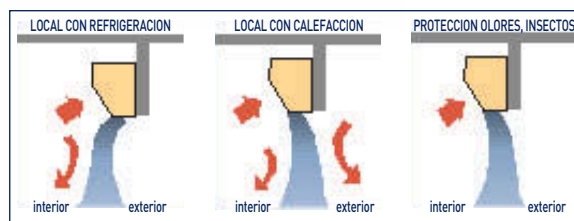
DIRECCION DEL FLUJO DEL AIRE
