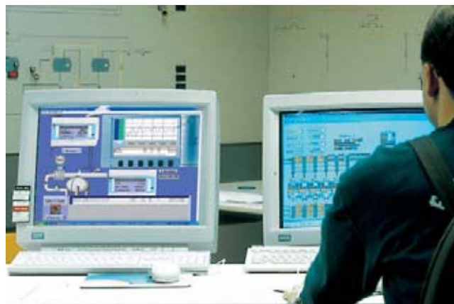
Visualización del proceso desde un puesto de control – una solución óptima cuando se lleva a cabo conjuntamente con un servidor OPC de Endress+Hauser.
