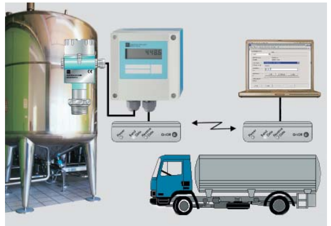
Medición del nivel de melaza en depósitos hechos a medida para un proveedor. El Minilog B almacena los datos sobre el consumo de clientes e informa al proveedor sobre el nivel actual de melaza en el depósito de almacenamiento. Los datos se recopilan en un punto de suministro central y están disponibles para la planificación de las entregas a tiempo.
