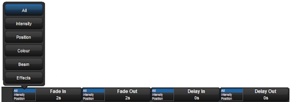
Figure 13.5. Sélection des types de paramètres depuis la Wheels Toolbar
