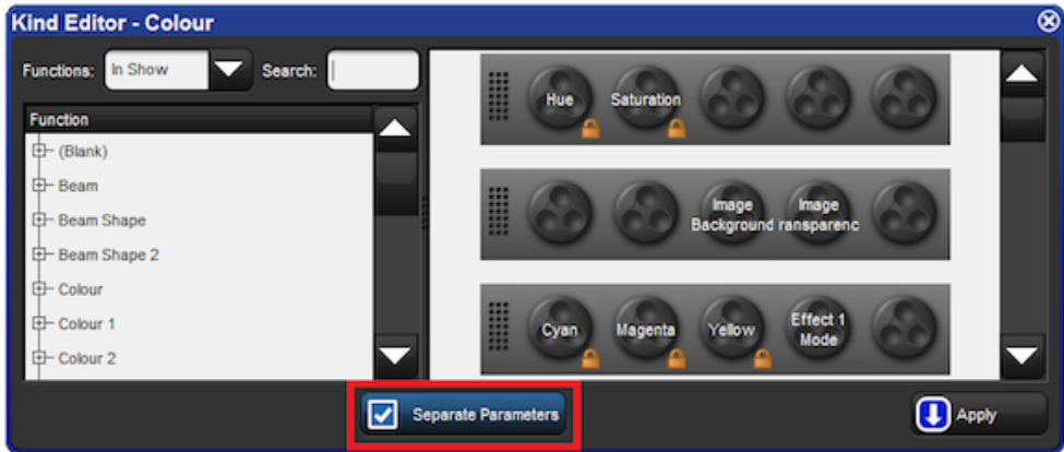
Figure 6.12. La fenêtre Kind Editor pour le genre Colour avec la case Paramètres Séparés cochée
