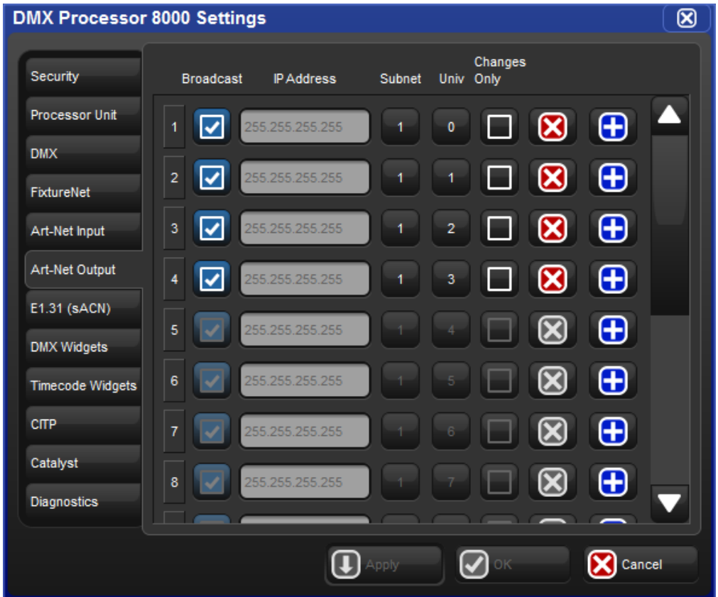
Figure 3.10. Onglet Art-Net Outputs de la fenêtre DMX Processor Settings
