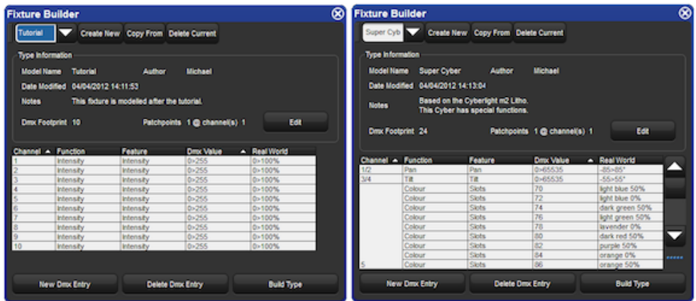
Figure 25.3. La fenêtre Fixture Builder
