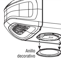
**3.** Desatornille la cámara lentamente de la carcasa del abre-puertas.
