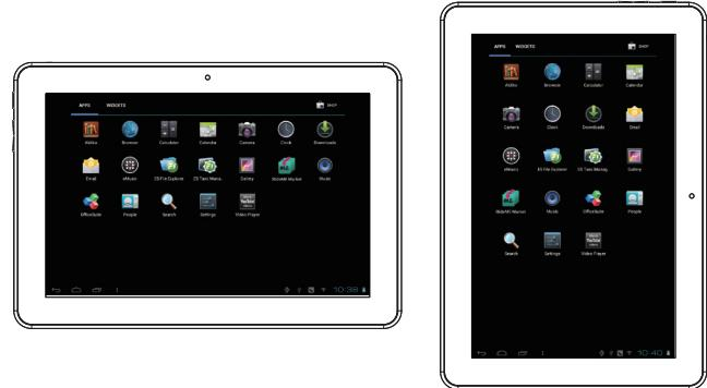
El sensor de orientación puede activarse y desactivarse desde el menú de configuraciones **Display** de la pantalla.
