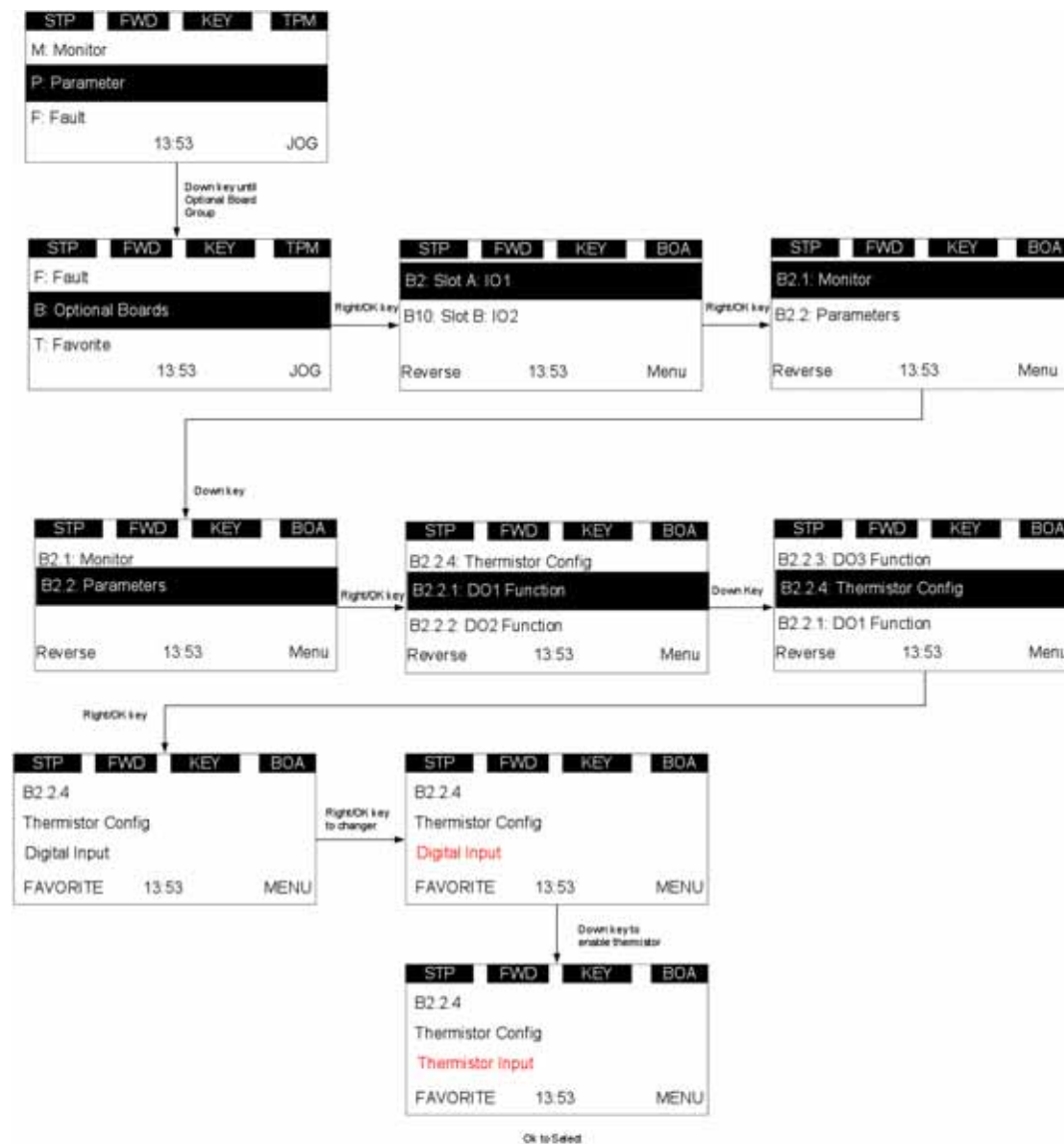
Figura 12. Ajuste de parámetros del termistor
