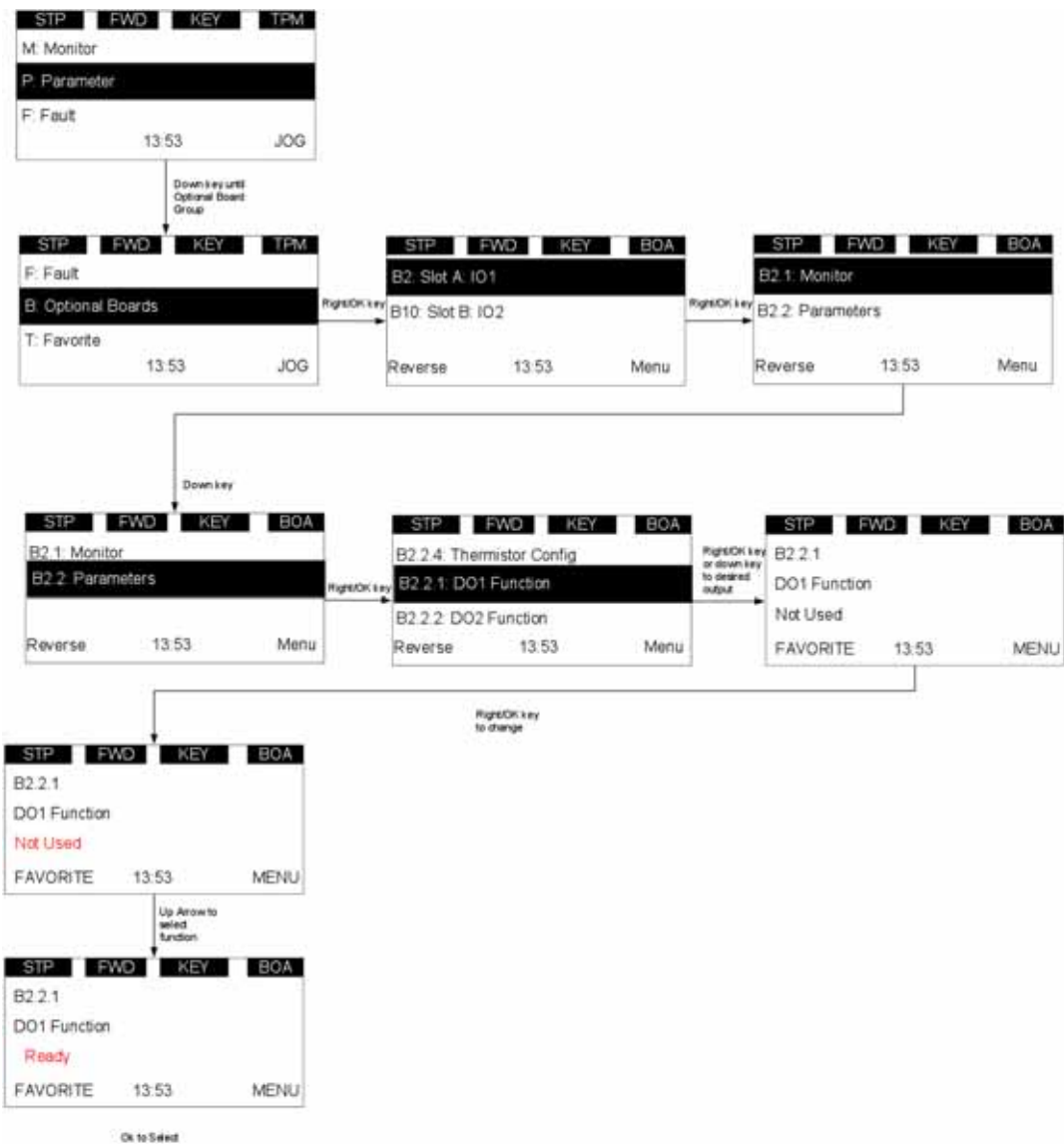
Figura 11. Programación de la señal de salida digital
