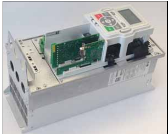
Abbildung 4. Ansicht der Steuerplatine des Antriebs mit Einschüben für Optionskarten
