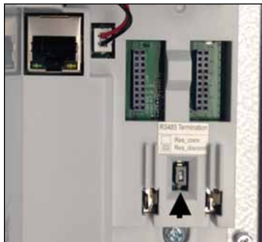
Abbildung 8. Abschlusswiderstand und Abschirmung
