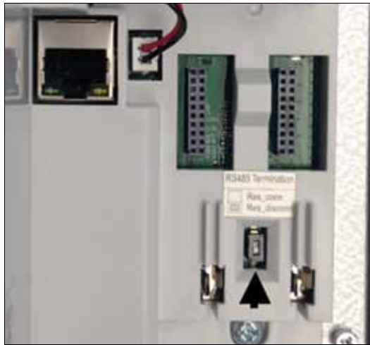
Abbildung 33. RS-485 Busabschluss Setup
