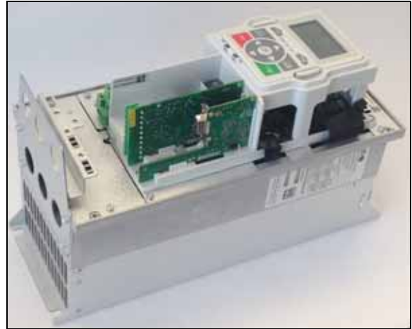
Ilustracja 4. Widok płyty sterującej przemiennika z gniazdami kart rozszerzeń
