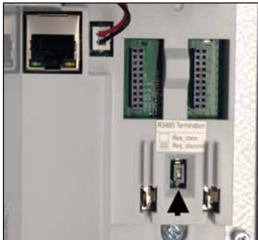
Ilustracja 8. Rezystor terminujący i ekran
