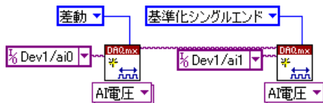
図 4-3. LabVIEW でマルチモードスキャンを有効にする
